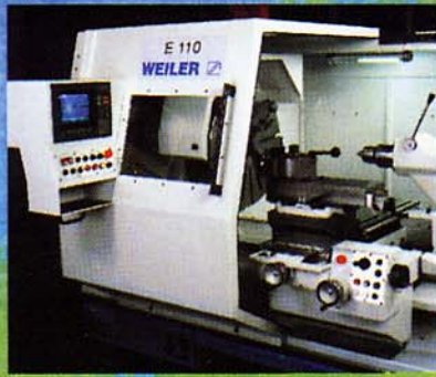
Anordnung des Bildschirms an der verfahrenbaren Spritzschutzhäube. Modelle E90 bis E120 Standard.
