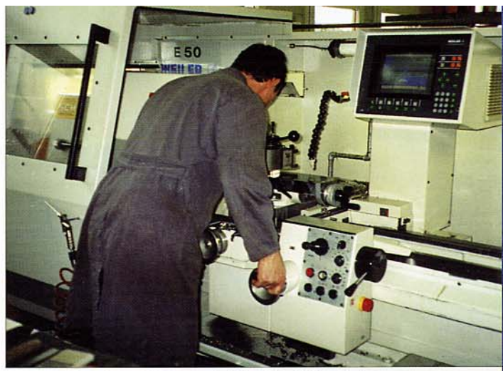
Ein weiterer Dichtungsteil wird auf der E50 gefertigt.
