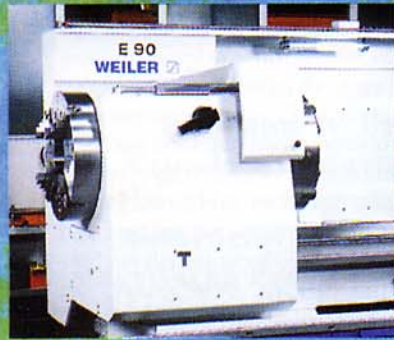
Ausführung große Spindelbohrung mit Vorder- und Hinterendfutter für die Endenbearbeitung von langen Werkstücken.
