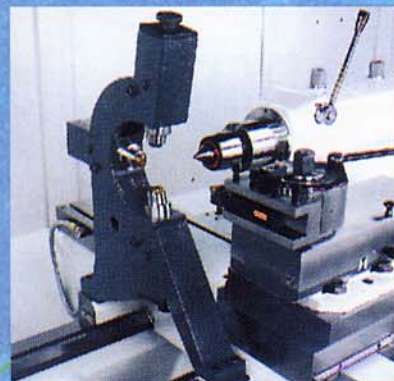
Mitlaufende Lünette zur Aufnahme des Schnittdruckes bei der Bearbeitung von langen, schlanken Werkstücken.
