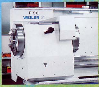
Ausführung große Spindelbohrung mit Vorderend- und Hinterendfutter für die Endenbearbeitung von langen Werkstücken.
