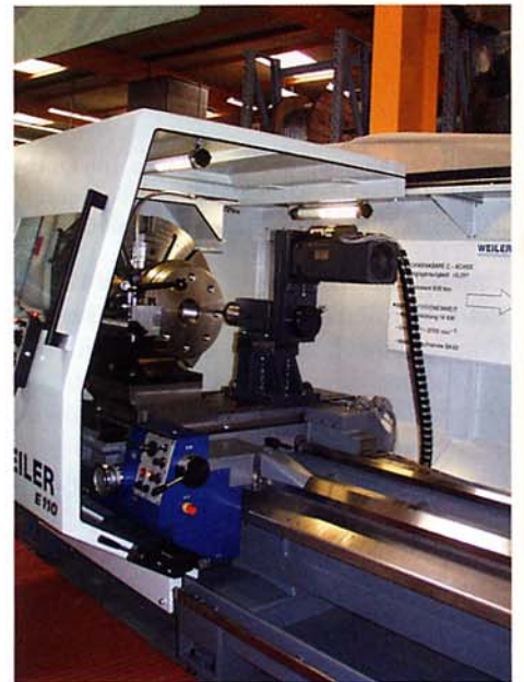
Bild 2: Zusatzeinrichtungen, wie hier die Bohr-/Fräseinheit, erlauben an den Zyklen-drehmaschinen beachtlich komplexe Komplettbearbeitungen
