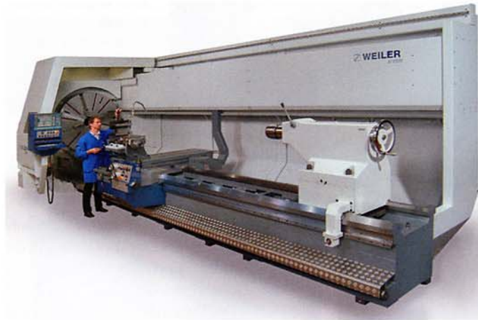
Bild 1: So sehen die ganz großen Zyklenmaschinen von Weiler aus, auf denen Großdrehteile bis zu 12 m Länge komplett bearbeitet werden können. Sie erinnern mit ihrem horizontalen Bett stark an die traditionellen Drehbänke. Und gerade dieses Bett bringt bei den großen Spitzenweiten mehr Präzision, als Schrägbetten
