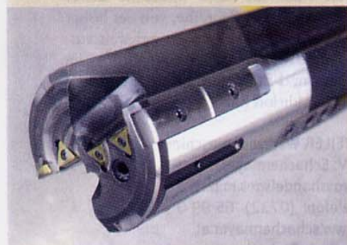
Derartige Tiefbohrwerkzeuge fordern von den Spindelantrieben dauerhaft hohe Leistung bei niedriger Drehzahl, ein hohes Antriebsmoment sowie gewaltige Vorschubkräfte insbesondere in der Z-Achse.
