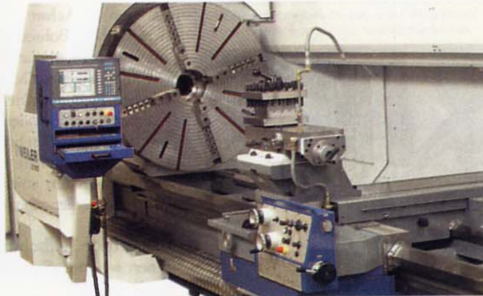
Die Optik macht deutlich, was es bedeutet, Werkstücke von bis zu 12 Tonnen zu spannen.
