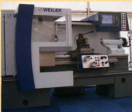
Neues Design für Mensch und Maschine: Weilers jüngste Entwicklung, die Zyklen-Drehmaschine E55 (Bild: Industrieanzeiger)
